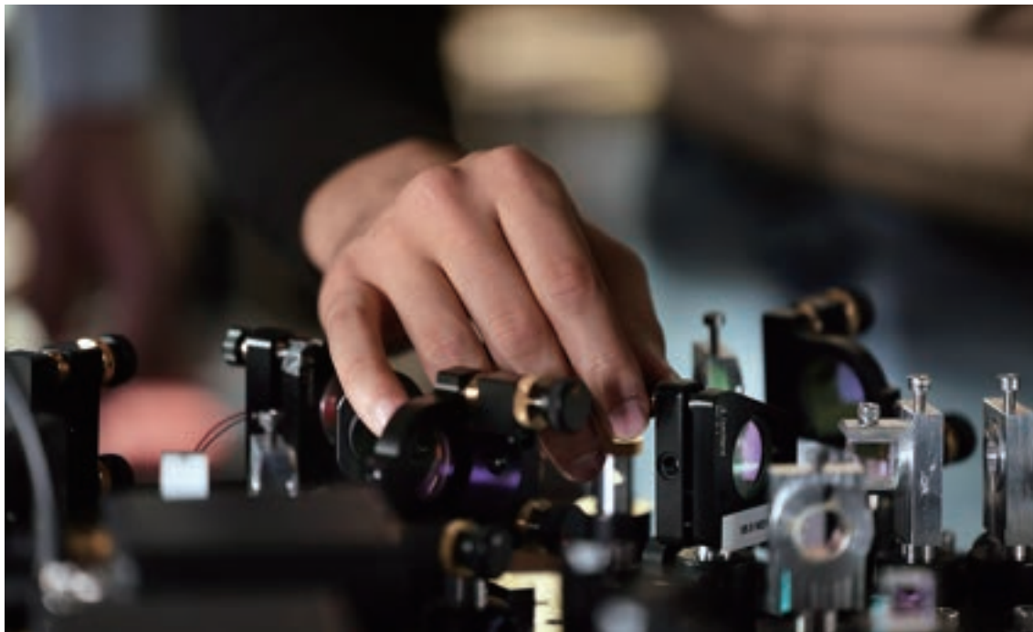
図2 チームの実験用に光学系のアライメントを行うカリーム・ハリ氏
