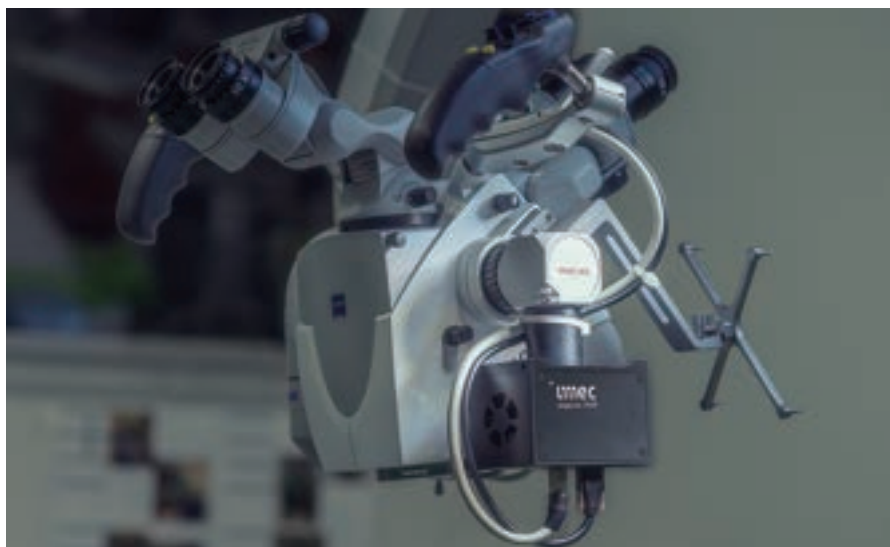
図1 小型形状と標準Cマウント光学系との互換性により、imec製SNAPSCANカメラは標準の手術用顕微鏡に容易に搭載できる(写真提供:imec)
