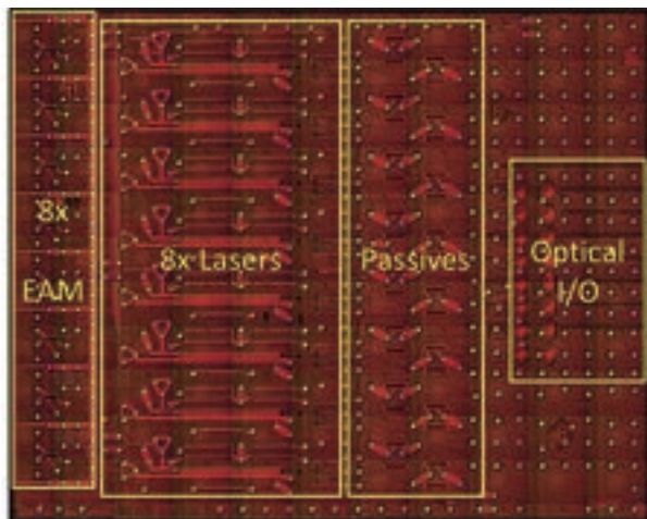
図1 オープンライト社の800G DR8フォトニクス集積回路設計(提供:オープンライト社)
