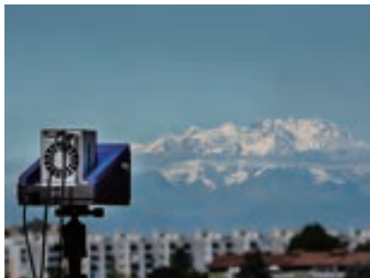
図4 ニレオス社の「HERA」カメラ。拡張SWIR-3領域(900~2300nm)をカバーする(提供:ニレオス社)
