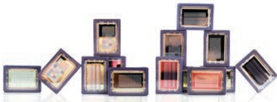
図3 imecの一連のハイパースペクトルセンサ。分光フィルタがモザイクまたはストライプのパターンで、イメージセンサに適用されている(提供:imec)
