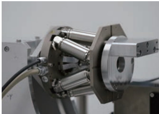
図5 ロボティックオートメーションの進歩により、アクティブアライメントの実装は容易になった。例えば、この自動ヘキサポッドは、アセンブリ中の光学素子の高精度なアライメントに使用される
