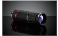
[1064nm 2X - 8X Gemma™ 可変ビームエキスパンダー](#)は、ガウシアンビームを念頭に置いたデザインで、ガリレオ式デザインの非回転レンズの採用とゴーストの無いフォーカスにより、158mmというコンパクトな鏡筒長を維持しながら高いポインティング精度を実現する。また、1064nm、10ns、20Hzで最大10 J/cm<sup>2</sup>のハイパワーレーザーパルスに耐えながら優れた透過率を実現するため、反射防止コーティングが施されている。Gemma™ 可変ビームエキスパンダーは、在庫販売による短納期対応が可能となっている。
