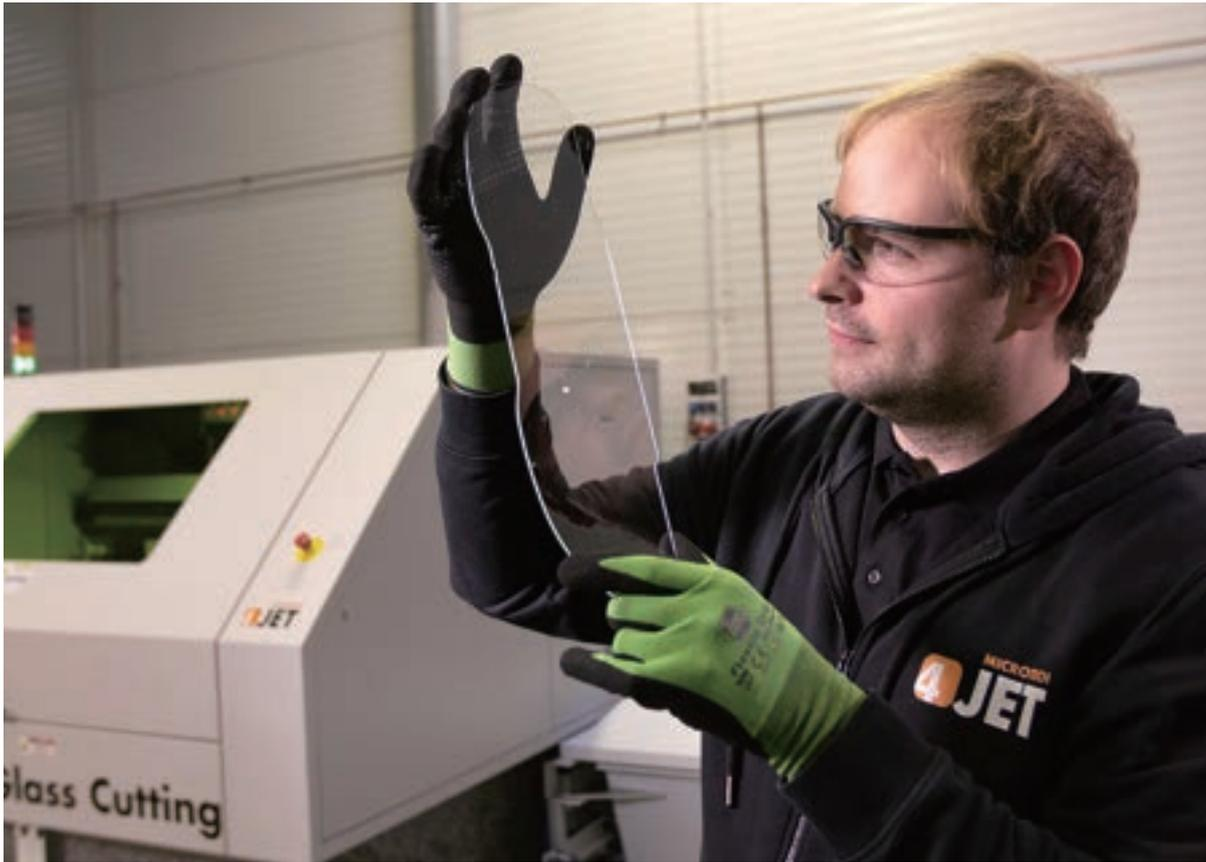
レーザーで切断した薄板ガラス片の検査(写真提供:4JET社)
