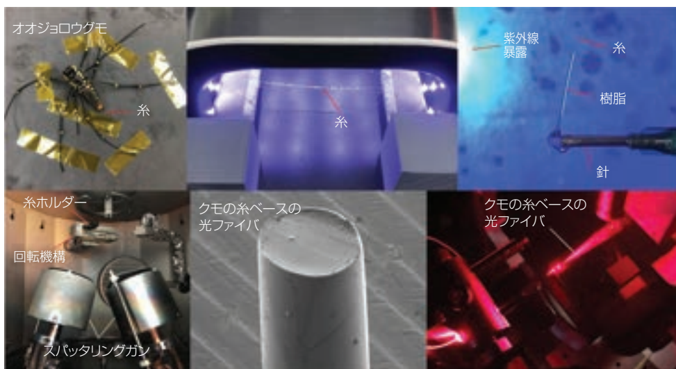
図 クモの糸を光ファイバとして利用し、研究者は、身体の血糖や他の生化学的分析物をリアルタイムで検出するセンサを作ろうとしている
