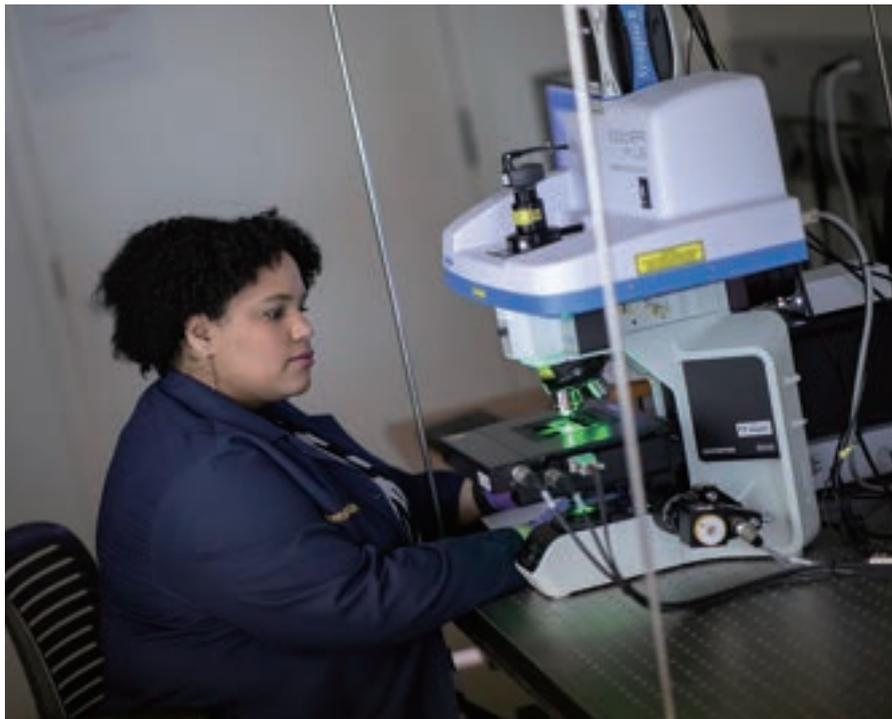
図2 新システムは、体液を画像化するためにアレクシス・ウェーバー氏が操作する共焦点ラマン分光計とレーザー光を使うラマン分光法で動作する
