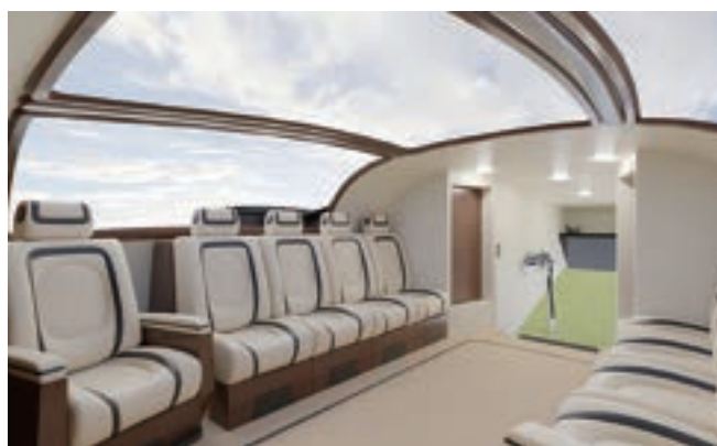
図3 米エアロGアビエーション社（AeroG Aviation）の10人乗り用ハイブリッド式の空飛ぶクルマ「AG4」の室内キャビンの図では、天井全体が有機ELディスプレイで覆われ、景色などが外部カメラからディスプレイに映し出されることが示されている（提供：エアロG社）
