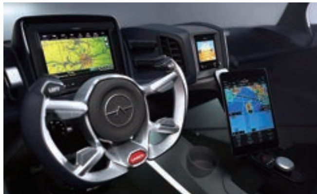
図2 エアロモービル社の「Flying Car 4.0」の内部には、超薄型でエネルギー効率の高い有機ELが最適な多数のディスプレイが見られる（提供：エアロモービル社）
