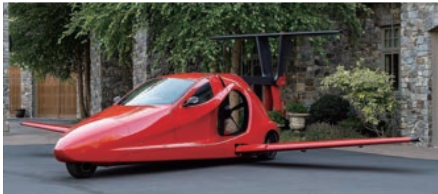
図8 サムソン・スカイ社製の3輪と折りたたみ式の翼を備えた、有人の空飛ぶクルマ「Switchblade」は、数か月後に納品するキットの予約注文を受け付けている。滑走路が必要で、数点の組み立てを必要とする(提供:サムソン・スカイ社)
