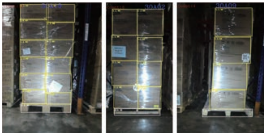
図1 AIを用いて段ボール箱を検出・計数したドローン画像の例
