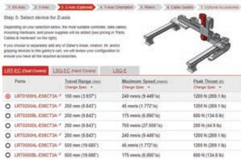
図4 多軸モーション制御システムのプランニングのための構成ツールの画面例。このようなツールは、ステップバイステップのガイダンスによって、正しいデバイスの選択に加えて、各デバイスを適切な向きに取り付けるために必要となる、すべての配線、支持具、取付具も用意できるように、支援してくれる
