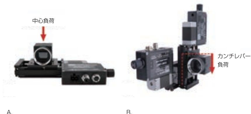
図3 標準的な水平方向の場合、ステージに対して推奨される最大負荷は、最大中心負荷の仕様によって定義される(A)。垂直方向の場合は(B)、カンチレバー負荷を考慮しなければならない。垂直方向のステージには、重力に逆らってこの負荷を持ち上げられるだけのスラストが必要である
