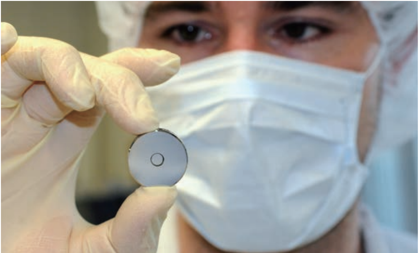
図2 アト秒レーザービームの操作に使用されるEUVアト秒多層膜ミラー。
