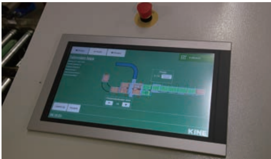
図3 オペレータは、この操作ステーションから製造工程全体を管理し、速度とタイミングの定義と調整を行ったり、展開されているMatrox Design Assistant X プロジェクトの「オペレータビュー」にアクセスしたりすることができる
