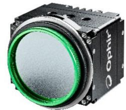
このカメラは、44.6dB の広いダイナミックレンジ、0.25nW/cm<sup>2</sup> の最小シグナル、NIR 領域での高精度を特長としています。SP504S カメラは、業界最小の 4.5 $\mu$ m ピクセルサイズ (競合製品よりも最大 3 分の 1 のサイズ) を提供します。これにより、より高い空間分解能と、より小さなビームサイズでのレーザービームの測定が可能になります。そのため、このカメラは、高解像度を必要とする大口径ビームのアプリケーションや、レーザー材料加工、VCSEL / LED、医療美容など、広い領域でビームプロファイル測定が必要な場合に最適です。
