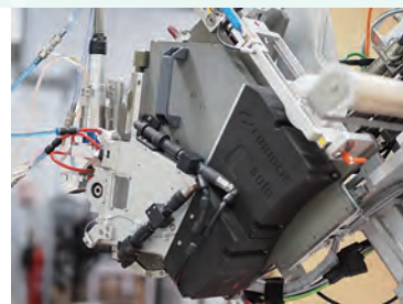
図2 カイラブズ社の繊維配置ヘッド(左側)を搭載した「Coriolis C-solo」のロボットアーム。
