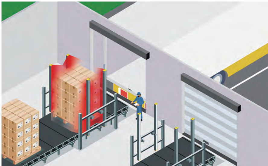
図4 パレットは、検査対象物として非常にサイズが大きく、視野全体を照らす大きな照明装置が必要である。物流照明ソリューションは、最大で長さ3mにも及ぶ場合がある。
