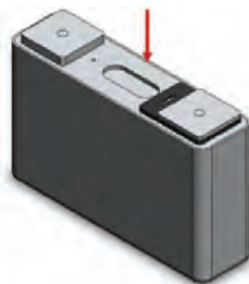
図1 マルチモードのリング状のファイバレーザビーム(CFXシリーズ)を使用して、2.5kWの出力と200mm/sの速度で行った、アルミニウム製の角型バッテリーセルの電池缶とキャップの溶接。
