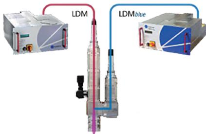
図1 ハイブリッドコンセプト。2波長により高品質、スパッタフリーとなる。ブルーレーザーの熱伝導溶接とマルチkWのIRレーザーを利用することで溶け込み深度が大きくなる。
