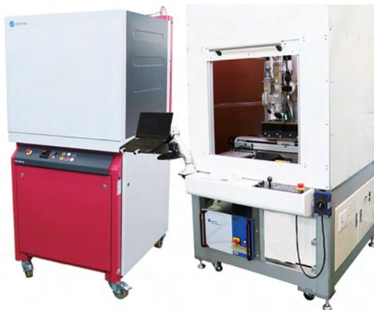
図2 ブルー IRハイブリッドレーザ加工機
