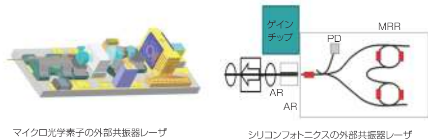
図2 マイクロ光学素子とシリコンフォトニクスをベースとした外部共振器レーザ。
