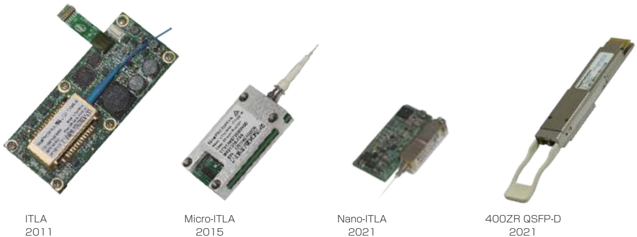
図4 コヒーレント時代(2011~2021年)のチューナブルレーザのフォームファクタの進化と、400ZRのコヒーレントトランシーバ。
