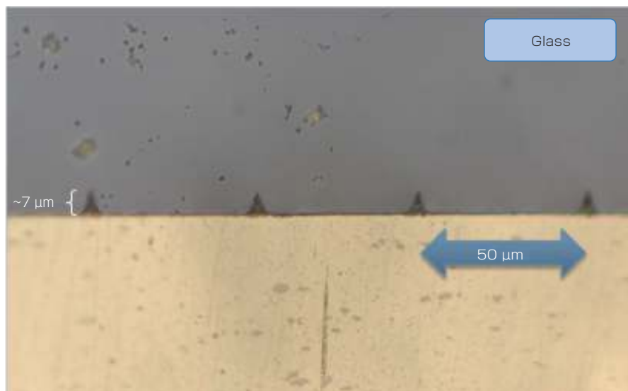
図6 断面の顕微鏡画像には、熔融したアルミニウムがガラス板にはめ込まれて合金されているのが示されているが、2つの材料に亀裂や分離は見られない。
