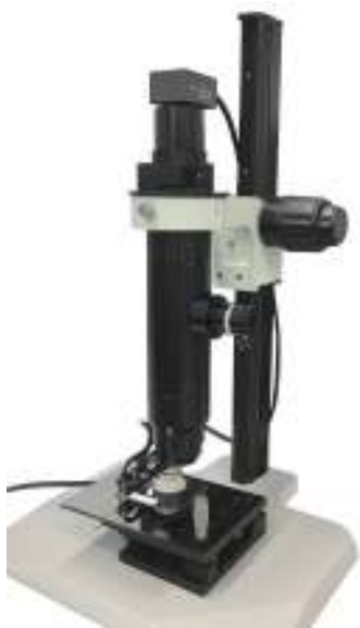
図9 この「Super Wide Angle 4K Imaging Lens」は、産業やライフサイエンス分野で顕微鏡を使用する顧客に対し、低倍率で高解像度のイメージングのための代替手段を提供する。(写真提供:ナビター社)
