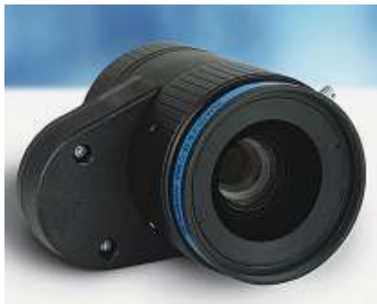
図2 「ELM-25-2.8-18-C」レンズは、焦点距離が25mm、F値は2.8、ピクセルサイズは 2.4\mu\text{m} で、1.1インチのセンササイズとCマウントのカメラに対応する。(写真提供:オプトチューン社)
