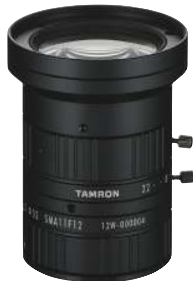
図11 産業用固定焦点レンズ「SMA 11F12」は、可視光からSWIR領域までの広い範囲で高い分光透過率を実現しつつ、その領域全体でピントずれを極限まで抑制する。(写真提供:タムロン)
