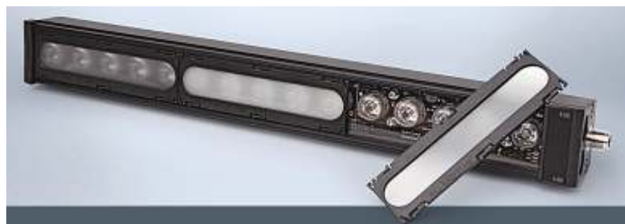
図3 TPLビジョン社の「Modular Bar with Angle Changers」には、マイクロオプティクス技術に基づく厚さわずか4 mmのフィルムが採用されており、それによって光出力角度を調整することにより、Modular Barの超狭角 (Ultra-Narrow) に加えて、狭角、中角、広角、ライン状の光を照射する。(写真提供: TPLビジョン社)
