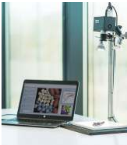
図5 スナップスキャンカメラは、高分解能の静止HS画像を撮影する。(画像提供: imec)
