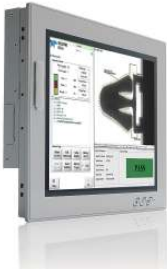
図3 テレダイナル社の「GEVA 312T」画像処理PCは、「iNspect」画像処理ソフトウェアを使用して、ライン上の「Genie NANO」カメラからのすべての画像を評価する。(写真提供:テレダイナル社)
