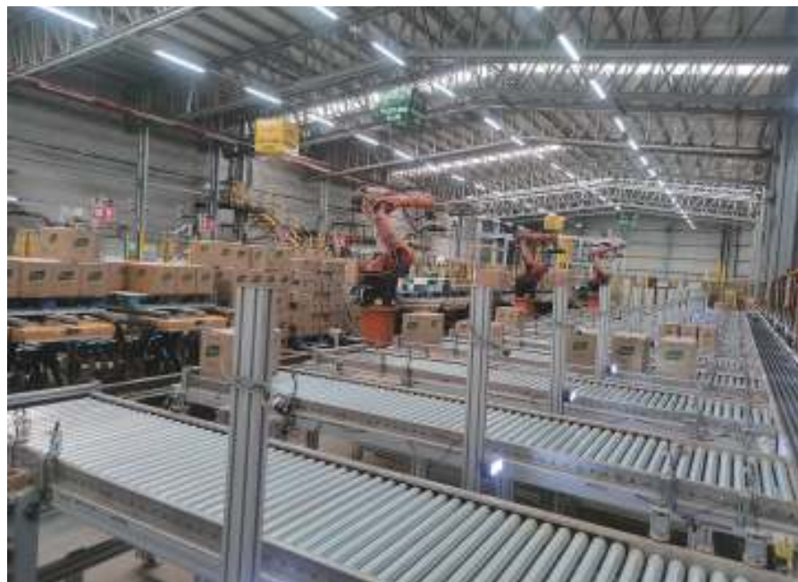
図1 小さな箱に入ったクノール社の商品が、19台のカメラによって識別されて、17のラインに仕分けされる。続いて3台のロボットによって、輸送に向けて1種類のパレットに積み上げられる。(写真提供:キベレPIMS社)
