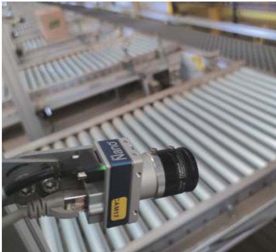
図2 17のラインのそれぞれに設置された1台のカメラによって、クノール社の商品が入った箱にパッケージの破損がないかの確認と、バーコードによる分類が行われる。(写真提供:キベレPIMS社)
