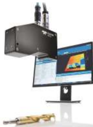
図5 「Z-Trak2」シリーズの3Dプロファイルセンサモデルは、1プロファイルあたり2,000ポイントを測定でき、工場校正済みで、IP67準拠の筐体に収められており、青色または赤色のアイセーフレーザーを採用し、最大45,000プロファイル/秒のスキャン速度を達成する。
