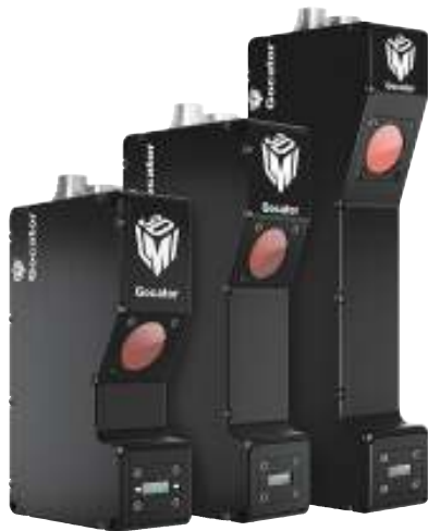
図4 3Dプロファイルセンサシリーズ「Gocator」に追加された青色レーザーモデルは、2MPのカメラや組み込みデュアルコアプロセッサを搭載し、多様な用途における光沢のある金属表面の3Dスキャンをターゲットとしている。
