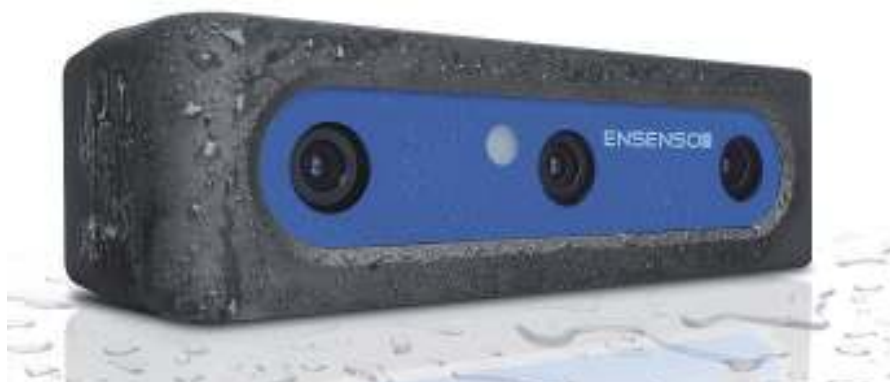
図3 プラスチック複合材でできたIDS社のEnsenso N40/45 3Dカメラは、軽量化されており、IP65/67保護等級のハウジングを備え、1280×1024ピクセルのモノクロCMOSイメージセンサを2台搭載する。
