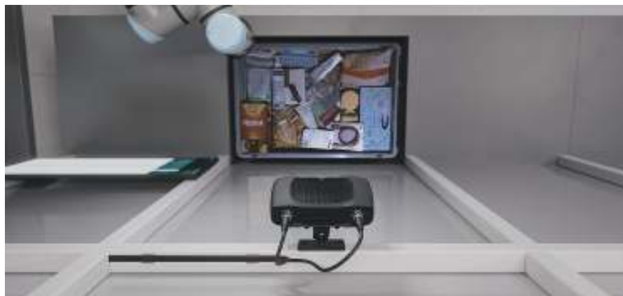
図2 Zivid Two 3Dカメラは、0.2%未満の寸法精度誤差と、ネイティブなHD 3Dカラーイメージングにより、ピンピッキングにおけるピックアンドブレースの成功率向上に貢献する。
