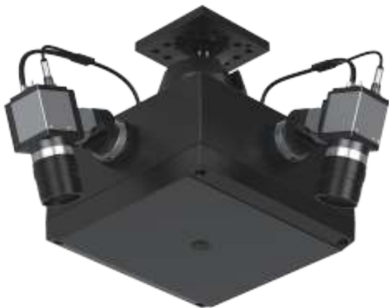
図8 サッカード・ビジョン社の多次元3Dイメージングシステムは、完全にプログラム可能で、動かすことのできるストラクチャードライトを利用することにより、部品やカメラを動かすことなく画像を取得することができる。
