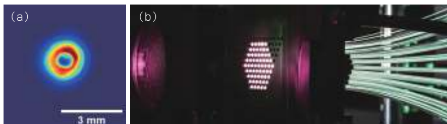
図2 XCANによって生成されたドーナツ型の遠方場(a)と、XCANのレーザーヘッド(b)。
