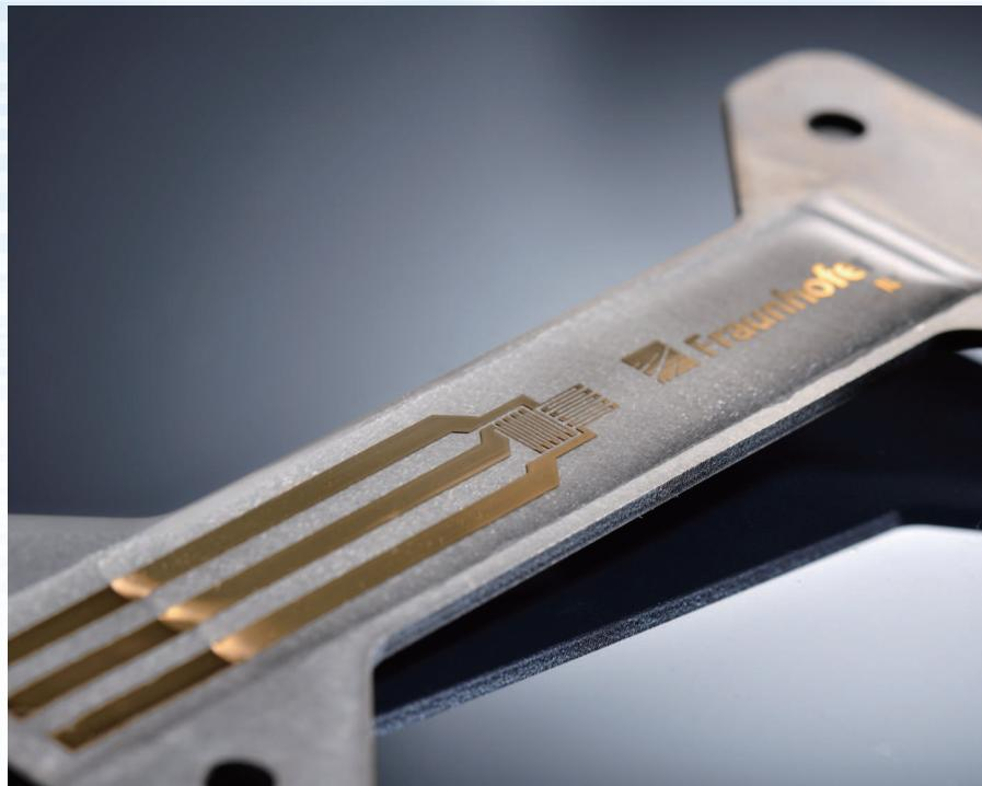
図4 積層造形によってスチール製部品に取り付けられたひずみゲージ。この写真的スチール部品にはテレメトリが組み込まれている。
