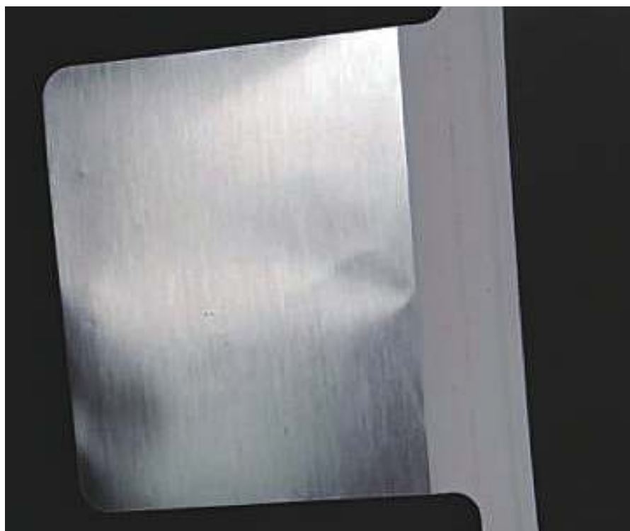
図1 セラミック層付きの陰極用アルミニウム板。
