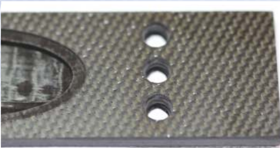
図6 マルチパス処理によって、3mmの炭素繊維強化プラスチックにあけられた穴。
