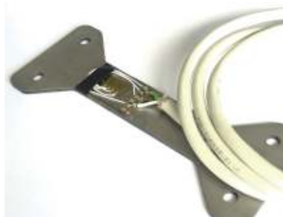
図1 従来の方法でステンレス鋼製の部品に貼り付けられた接続線付きのひずみゲージ(画像はすべてフラウンホーファーILT提供)。
