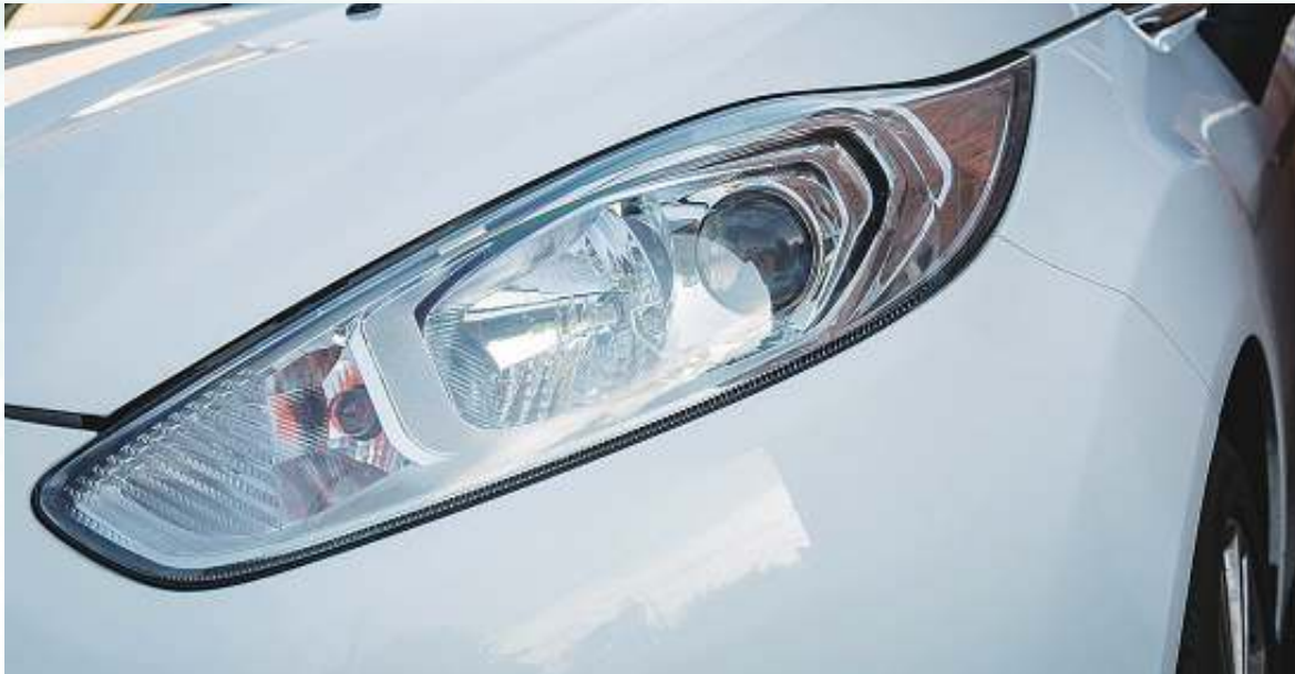
図4 ヘッドライトカバーのトリミングにもレーザーが使用されている。
