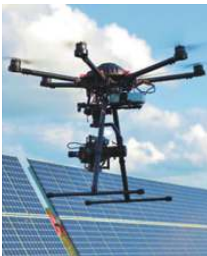
図3 太陽光発電所の太陽光発電(PV)パネルを検査するドローンに搭載されたVis-SWIRカメラ。
