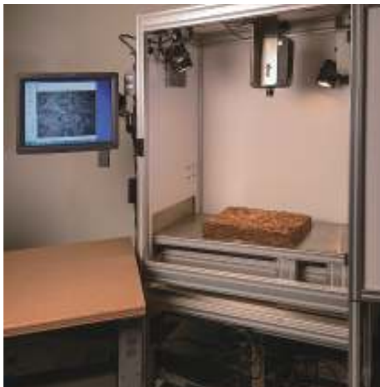
図1 タバコ葉ブレンド等級検証システムは、筐体、タングステンハロゲンランプ、冷却ファン、ハイパースペクトルカメラで構成される。
