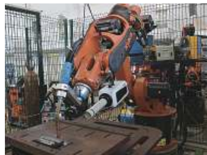
図3 Phantom高速カメラは、溶接時に電極を保持し、ジョイント部分に沿って導くロボットアームの下側に取り付けられている。
