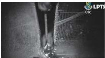
図1、2 直径1mm未満の溶接ジョイント部分を効果的に画像化。
