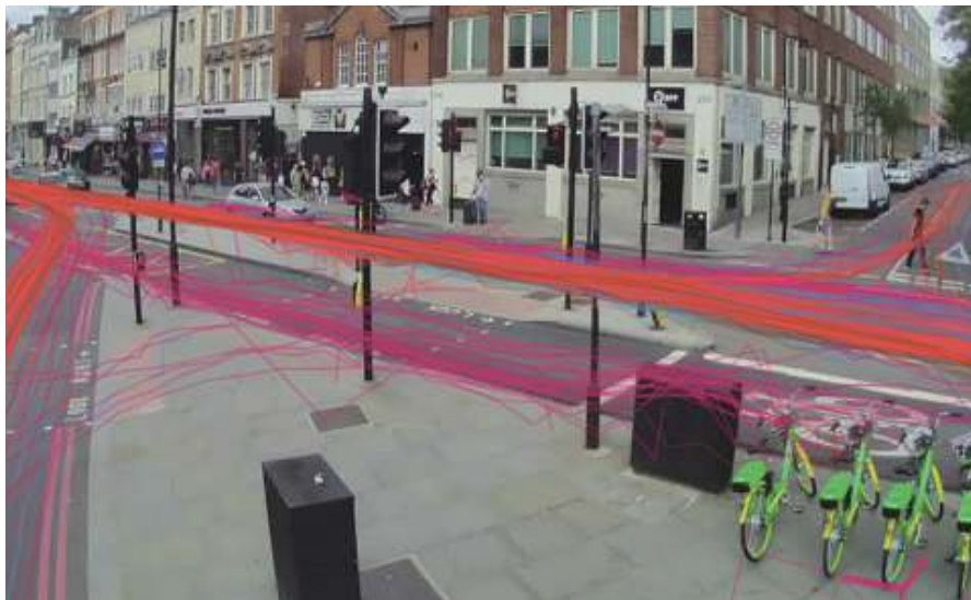
図2 ビバシティ・ラブズ社の独自の交通監視ソフトウェアは、ラインによって、自動車、歩行者、自転車が通った経路を示す。
