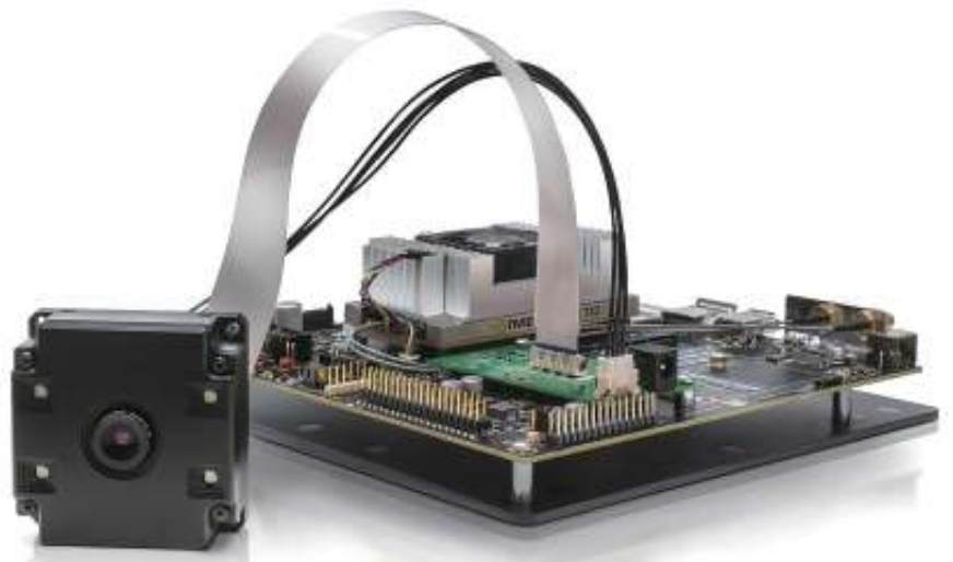
図1 ルシッド・ビジョン・ラブズ社のToFカメラ「Helios」は、独自の深度処理パイプラインを搭載し、ソニーのIMX556PLR DepthSense ToFセンサを採用して、30fpsのフレームレートと6mの作動距離で、640×480の解像度を実現する。
