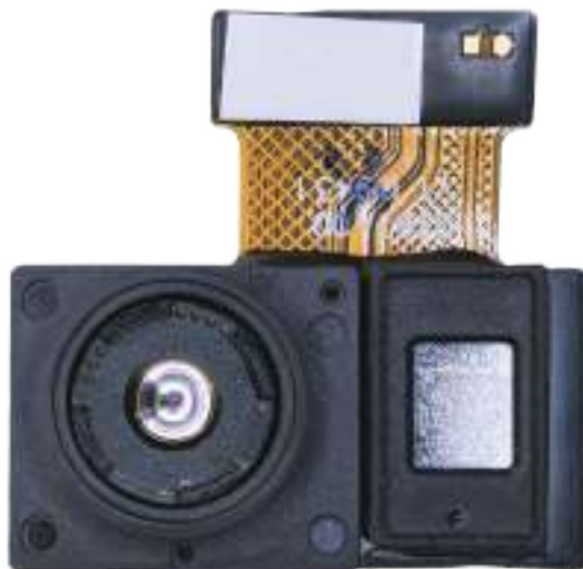
図2 pmdテクノロジー社はインフィニオン・テクノロジー社と共同で、3Dピクセルが1個から640×480個までのCMOS 3D ToFセンサを開発した。写真は、640×480のカメラモジュールである。
