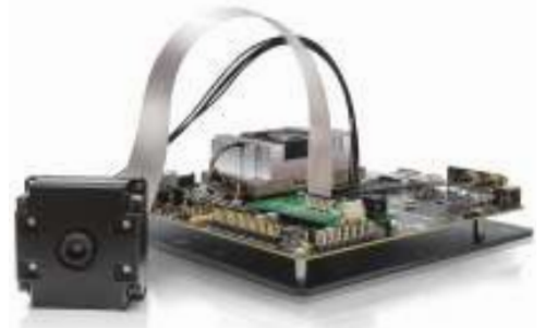
図2 ルシッド・ビジョン・ラブズ社の 3D ToF カメラ「Helios Flex」は、ソニーの ToF センサ「DepthSense IMX556PLR」を搭載し、MIPI CSI-2 インタフェースを備える。
