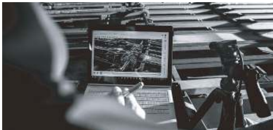
図3 RDIテクノロジー社の「Iris CM」システムには、3基のUSB 3.0カメラと、同社の特許技術であるビデオベースの振動計測が搭載されている。
