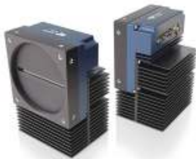
図8 テレダイン・ダルサ社の「Linea HS 32k」カメラには、16k×64のピクセルアレイ2個(ピクセルサイズは5×5μm)で構成される、同社のチャージドメイン(電荷加算型)CMOS TDIセンサが採用されている。フレームグラバによるデータ再構築後、200kHzのラインレート、6.5GB/secで、32k/2.5μmの超高解像度画像を出力する。
