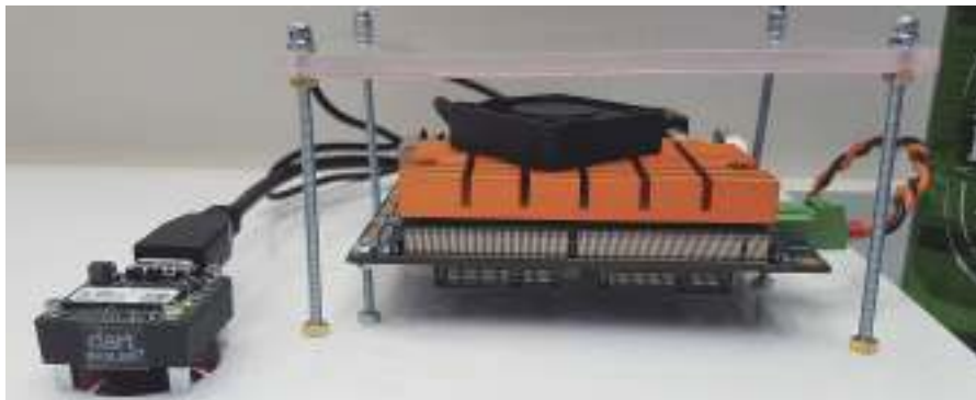
図1 図中のプロトタイプデバイスは、バスラー社のSマウントレンズ装備のMIPI CSI-2カメラ、NXPセミコンダクターズ社のアプリケーションプロセッサ「i.MX 8M」をベースとしたコンガテック社のSMARC 2.0コンピュータ・オン・モジュール「SMX8」、イリダ・ラブズ社のディープラーニングソフトウェアで構成されている。
