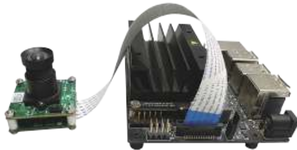
図3 カラー、モノクロ、NIR、RAW Bayerの各フォーマットで提供されている、イーコン・システムズ社の組み込みビジョンカメラは、この図に示されているエヌビディア社のJetson Nanoなどの組み込みビジョン開発キットとともに使用できるように設計されている。
