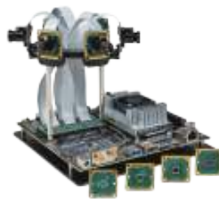
図5 イメージング・ソース社のボードレベルのMIPI CSI-2カメラは、エヌビディア社のJetson Nano／TX2／AGX XavierとRaspberry Piに直接アクセス可能で、ソニーの0.3～8.3メガピクセルのPregiusまたはSTARVISセンサを搭載する。
