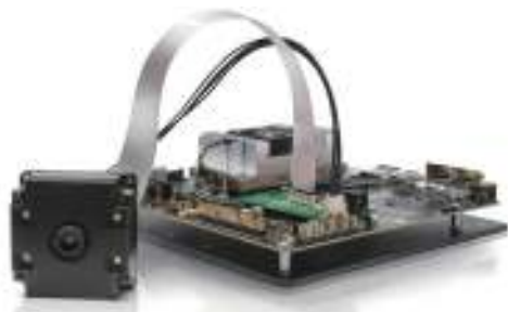
図4 ルシッド・ビジョン・ラブズ社のHelios Flexカメラは、ソニーのDepthSense IMX556センサを搭載し、Jetson TX2のGPU上のCUDAアクセラレーション処理に向けて未加工データをオフロードする。
