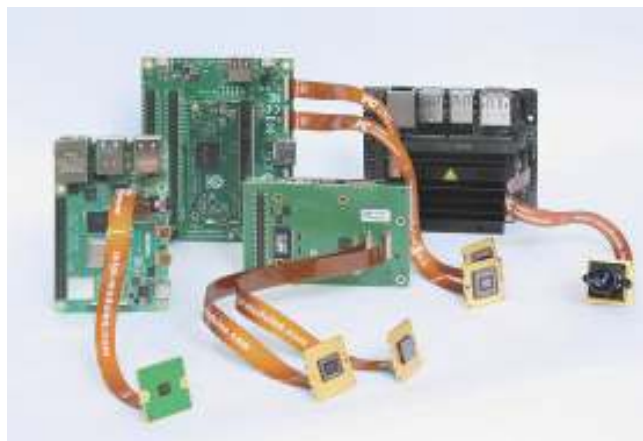
図6 エヌビディア社、ラズベリー財団、ロックチップ社、アロー社、NXPセミコンダクター社などのCPUボードに対応する、ビジョン・コンポーネンツ社のVC MIPIモデルには、ソニーのPregiusまたはSTARVISセンサが採用されており、ピクセルサイズは0.3～20.2メガピクセルである。
