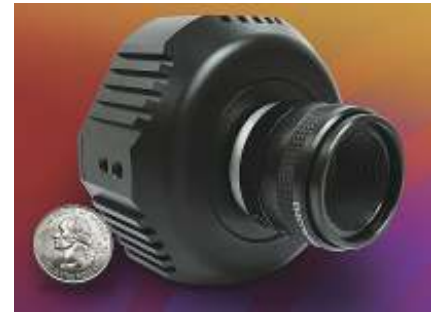
図7 プリンストン・インフリアード・テクノロジーズ社の「LineCam12」カメラは、1024×1のInGaAsセンサに基づいている。基板除去処理を利用することにより、リニアアレイに可視域(0.4～1.7μm)の応答感度を持たせている。
