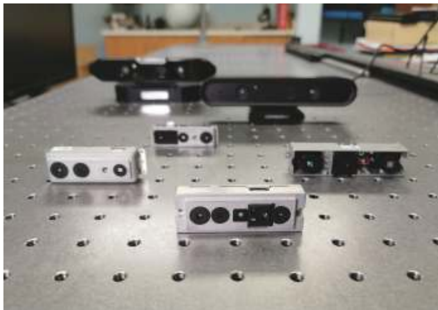
図2 オーベック社は、Astraシリーズの3Dカメラの4つの基本モデル(モデルごとに一部違いがある)と、Perseeモデルのカメラ(後ろ左側)を製造している。
