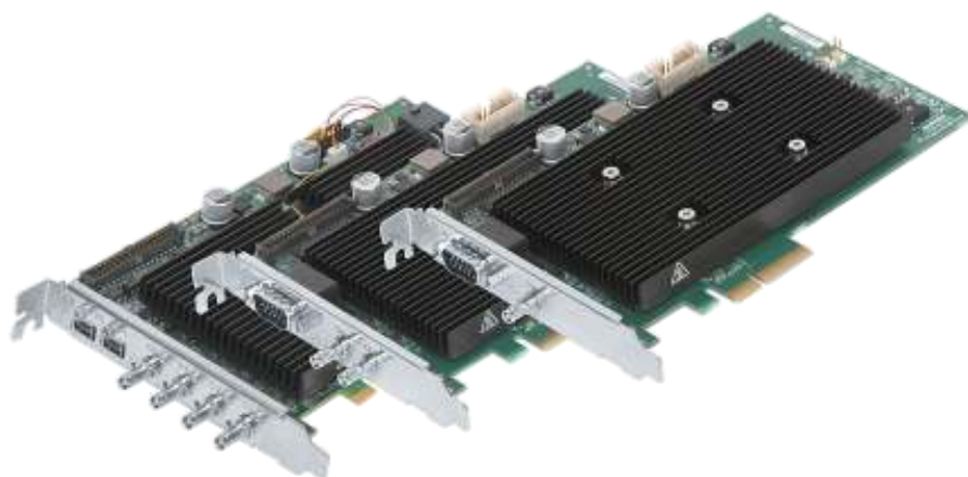
図6 「Matrox Rapixo CXP」フレームグラバは、1接続あたり最大 6.25 Gbps (CXP-6) または 12.5 Gbps (CXP-12) のデータレートに対応し、最大4接続をサポートする。
