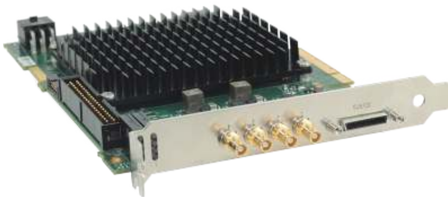
図7 「Xtium2-CXP」フレームグラバは、PCIe Gen 3 x8プラットフォームのシングル/デュアル/クワッドポートモデルで提供されており、1チャンネルあたり12.5Gbpsで、最大4つのCXP-12入力チャンネルからの画像取得をサポートする。
