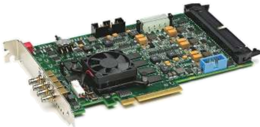
図3 1~4基のCXP 2.0カメラをサポートする、ビットフロー社のCXP-12 PCIe Gen 3フレームグラバ「Claxon」は、フレームグラバを介したデータ速度は倍増しているが、アーキテクチャは1つ前の世代の「Cyton」と同じである。
