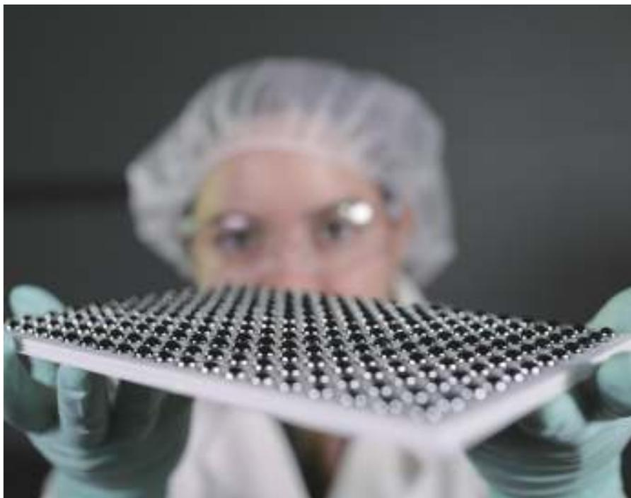
図2 研磨された球状のプリフォームは、IRカメラシステム用の非球面レンズの高精度な成形によって作成されている。このようなレンズや光学システムは現在、新型コロナウイルスの世界的感染拡大で需要が高まっており、体温を測定し、ウイルス感染検査が必要かどうかを判定するための非接触型のサーモメーターに使われている。
