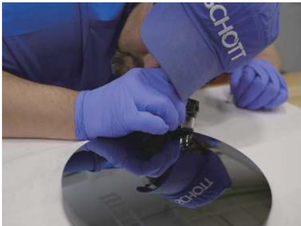
図1 ペンシルベニア州デュリエにあるショット社の施設では、アイルーペ、標準的な白色光干渉計、テストめっきを用いて、作製した材料の詳細検査を行う。
