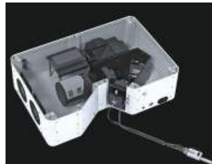
図4 完全集積バイオラマンシステムには、分光器、ディテクタ、レーザ、サンプルチャンバー、及びソフトウェアが含まれる。光ファイバ接続用のポートも提供されている。
