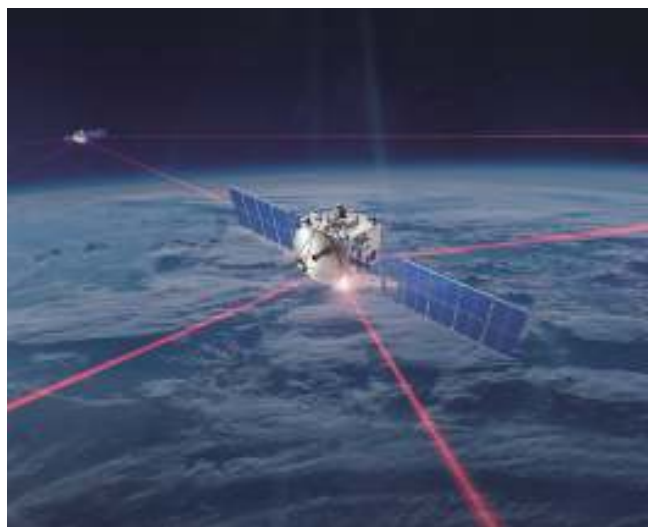
図1 低地球軌道上の衛星間をつなぐレーザーリンクは、地球までの無線リンクとともに世界ワイヤレスネットワークのバックボーンを形成する。(提供: マイナリック社)
