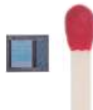
図3 PMDテクノロジー社のCMOS 3D ToFセンサは、同社独自のピクセルマトリックスをベースとし、224×172、352×288、448×336の解像度で提供されている。2020年にはさらに高い解像度のものが追加される予定である。
