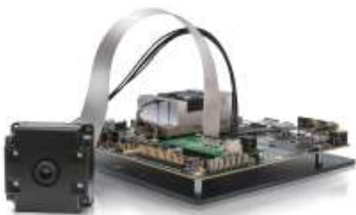
図1 ルーシッド・ビジョン・ラボ社の3Dカメラモジュール「Helios Flex」は、エヌビディア社の「Jetson TX2」に接続するように設計されており、MIPI接続を介して60fpsで未加工データを伝送する。
