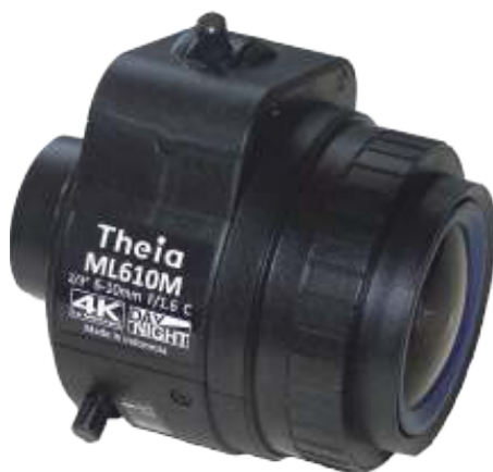
図4 ティア・テクノロジーズ社の「ML610M」は、焦点距離が6～10mmの範囲で可変のバリフォーカルCマウントレンズで、450～950nmの波長範囲を透過できる。
