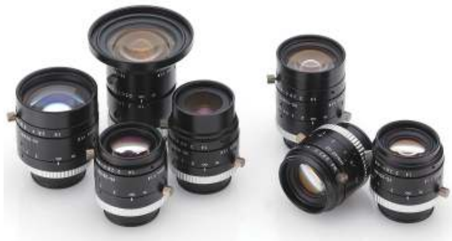
図3 「VS-H1-SWIR」シリーズのレンズは、6～50mmの焦点距離で提供されており、700～2000nmの波長範囲を透過する。
