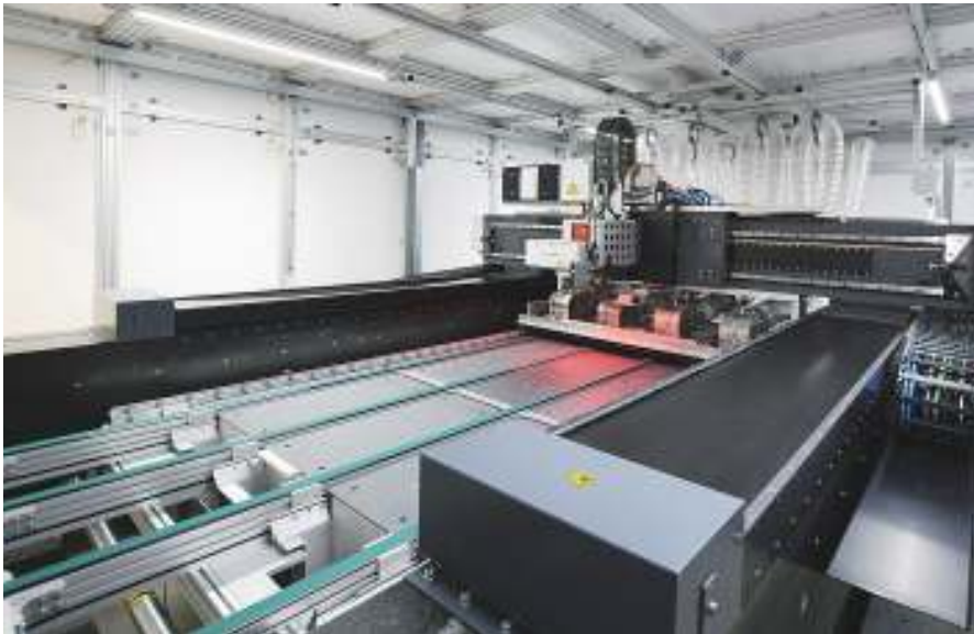
図2 大型基板を加工するmicroSHAPEレーザシステムの加工領域。
