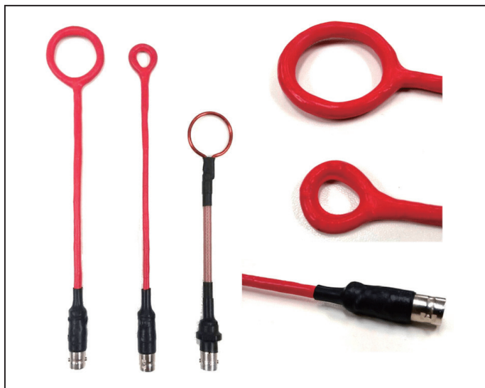
図1. 近磁界プローブ。右側が自作プローブを拡大したもの。
