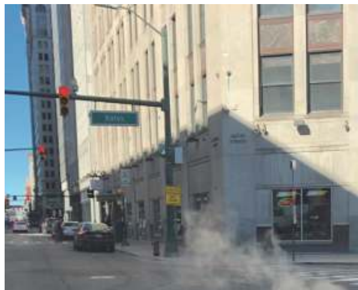
図3 この蒸気はライダーに反射光を返す可能性が高い。蒸気の中での走行が安全かどうかを自動車は判断できるだろうか。
